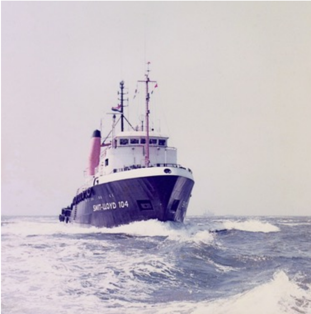
De Smit-Lloyd 104 op zijn proefvaart in 1973. Koning heeft dit nieuwe schip van de werf De Waal in Zaltbommel gehaald. Het was de eerste supplier met 8000 PK (wat later nog te weinig bleek...).
